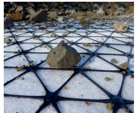
Geokunststoffe: Propex (Bändchengewebe), Fortrac (Geogitter), TriAx (triaxiales Geogitter).
