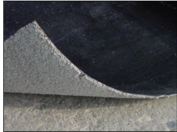
Abb. 3: Tondichtungsbahn mit HDPE-Folie (Tonazzi AG, DUALSEAL®)
