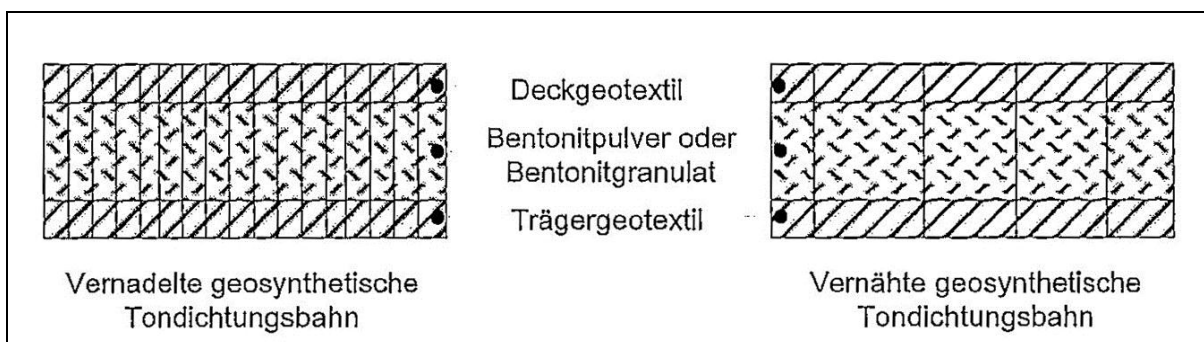
Abb. 1: Aufbau von geosynthetischen Tondichtungsbahnen (Quelle: EAG-GTD Empfehlungen [1])
