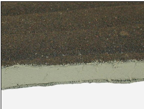
Abb. 2: Sandrau beschichtete Oberflächen (Schoellkopf AG, NaBento® RL-N)
