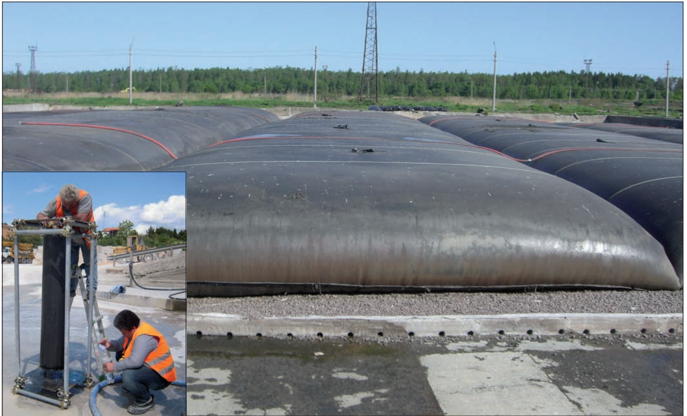
Essai de filtration au moyen d'un sac suspendu
